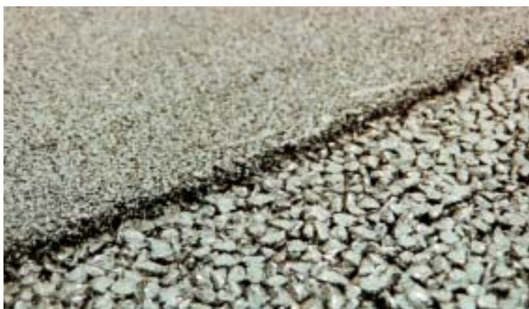
Figuur 2 Tweelaags ZOAB bestaat uit een top laag gelegen op een onderlaag
