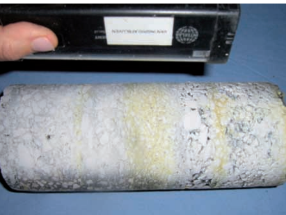
Verkleuring zonder UV-licht (verplicht bij toetsing) toont al teer aan
