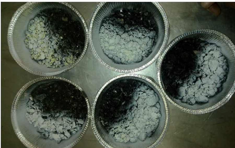
Vijf bakjes met gevarieerd gehalte teerhoudend asfaltgranulaat
