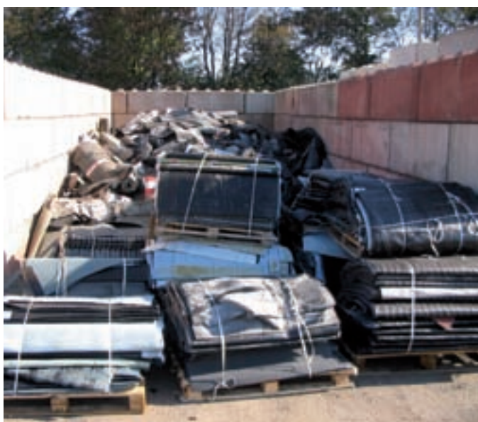
Oud dakbedekkingsmateriaal ligt gereed om tot granulaat te bewerken
