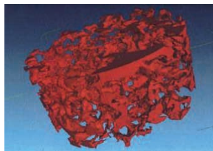
Onderzoek aan de TU-Delft met CT-scan naar de 'doorlopende' open holle ruimte in ZOAB
