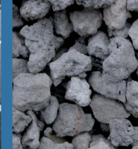
EOS-slakken in de Scorepave tussenlaag
