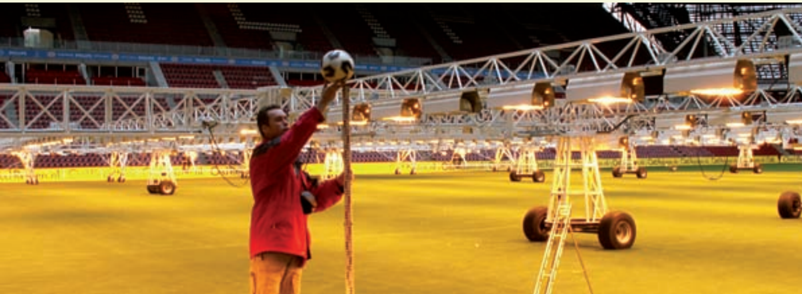
Vanaf een vastgestelde hoogte wordt de bal losgelaten. De stuithoogte wordt akoestisch geregistreerd. De balstuit moet tussen 0,60 en 1,00 meter liggen.
