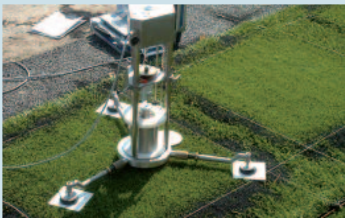
1. Onderzoek van sportfunctionele eigenschappen. Hier de vaststelling van de kwaliteit van het kunstgras met infill voor de energierestitutie van het veld.
