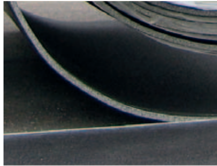
Zorgvuldig kromming van de mat in de gaten houden om een knik te voorkomen
