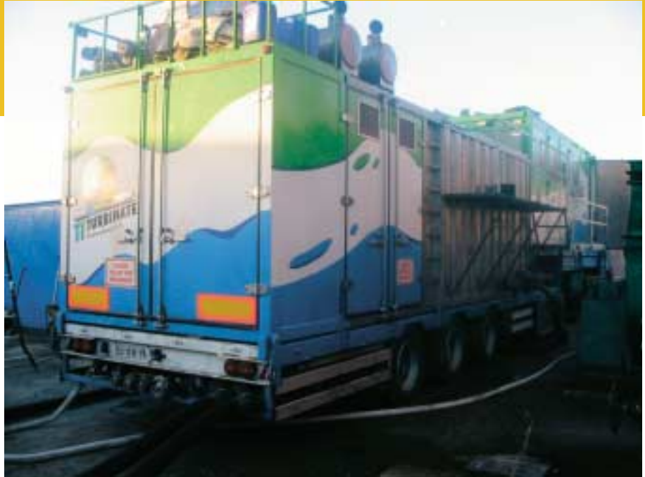
A. Verwarmde bitumentanks
