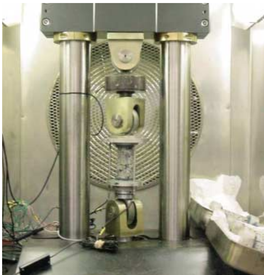
Uniaxiale trekopstelling met proefstuk combinatiedeklaag
