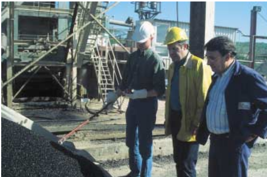
Mengproef in de asfaltcentrale
