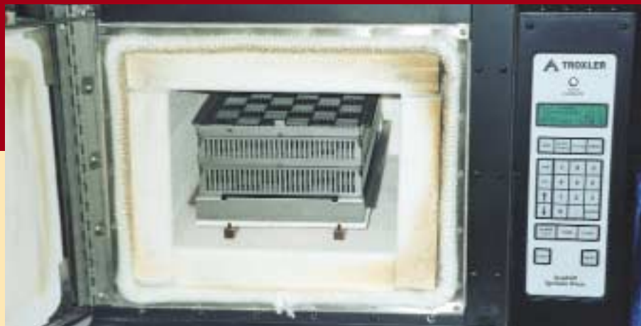
Tafelmodel verbrandingsoven levert binnen 20 tot 30 minuten bindmiddelgehalte
