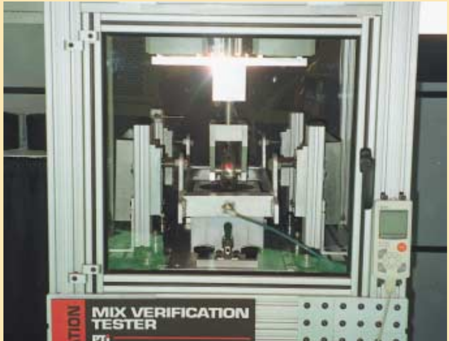
Asphalt Pavement Analyzer: mogelijk geschikt voor productiecontrole
