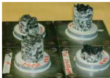
Proefstukken koude mengsels belast tot bezwijken
