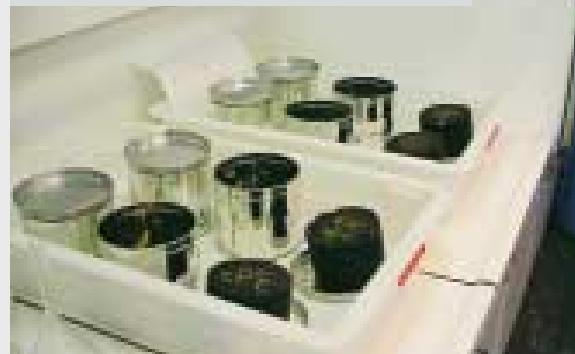
Ondergedompelde proefstukken in zuurkast bewaard
